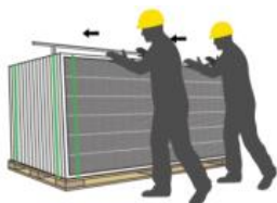
4. 剪断所有横向打包带，剩余1-2根竖向打包带时， 缓慢推动组件 靠向靠架或稳固支撑物
