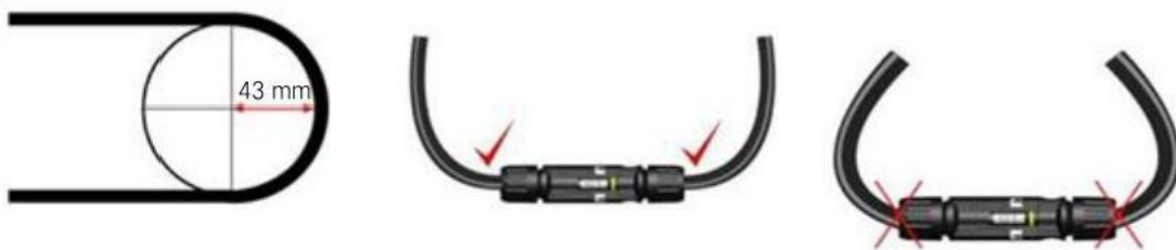
电缆的最小弯曲半径。
