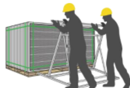
3. 放置拆箱靠架，注意 靠架应宽于或高于组件 防止顶撞玻璃造成组件破损
