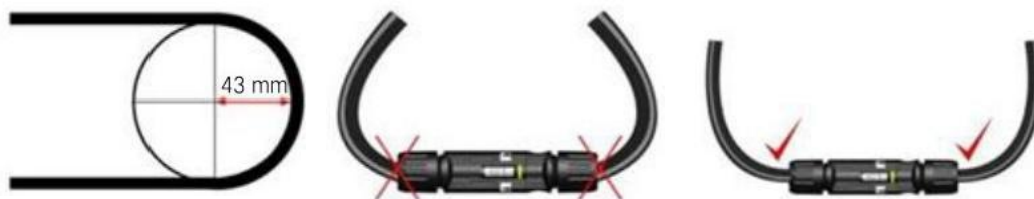
电缆的最小弯曲半径。
