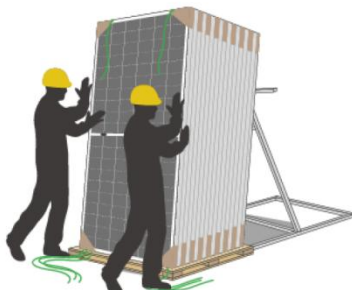
8. 剪断剩余打包带，使组件靠在靠架上
