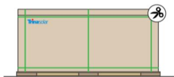
1 剪断外部打包带并去除缠绕膜
