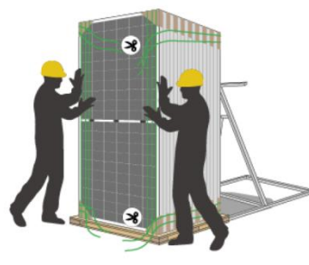
6. 剪断所有横向打包带
