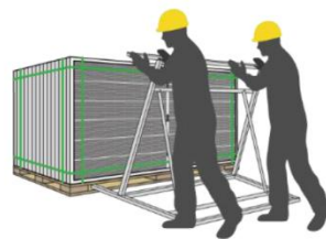
3 放置拆箱靠架，注意靠架应宽于或高于组件防止顶撞玻璃造成组件破损
