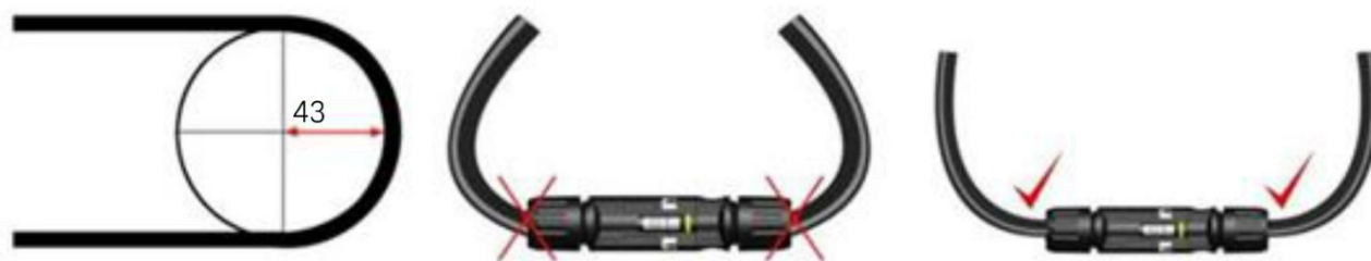
图6 电缆的最小弯曲半径
