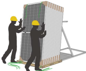
8. 剪断剩余打包带，使组件靠在靠架上
