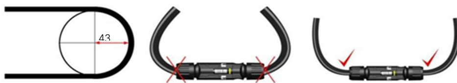
图5. 电缆的最小弯曲半径
