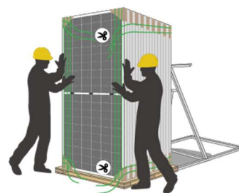
6. 剪断所有横向打包带
