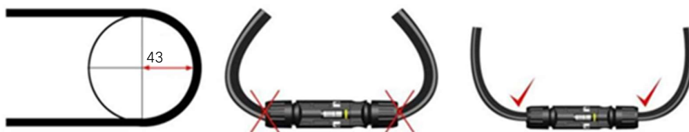
图5. 电缆的最小弯曲半径。
