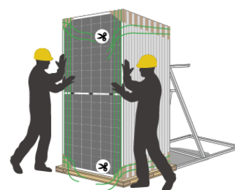
6) 水平梱包ベルトを切断
