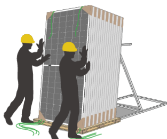
8) 残りの梱包ベルトを切断し治具に立てかけ安定させる
