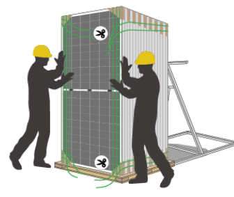
6) 水平梱包ベルトを切断
