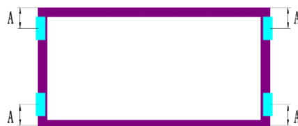
レール無し短辺 4 点クランプ固定
