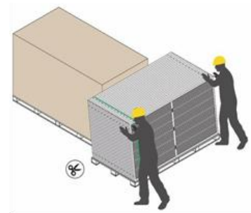
4) モジュールの両短辺に立ち、そつ と押してサポーターの方へ傾ける。 完全に安定してから残りの梱包 ベルトを切り離す
