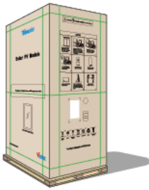
1) 外装フィルムと梱包ベルトを切断する
