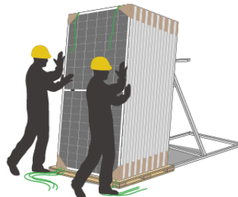
8) 残りの梱包ベルトを切断し治具に立てかけ安定させる
