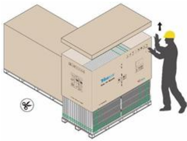
2) 包装フィルムと梱包ベルトを取り外し 上部カバーと段ボール箱を取り外す
