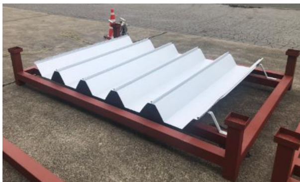
図 4. 日本式折板屋根固定イメージ
