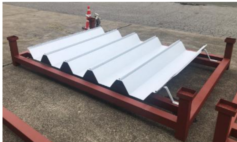
図 4. 日本式折板屋根固定イメージ
